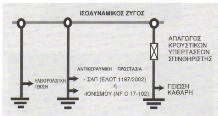
Εικόνα 7.3: Ενοποίηση γειώσεων σε ισοδυναμικό ζυγό. Άμεση σύνδεση των Αγωγών ηλεκτρολογικής και αντικεραυνικής γείωσης. Έμμεση σύνδεση της "καθαρής" γείωσης.
