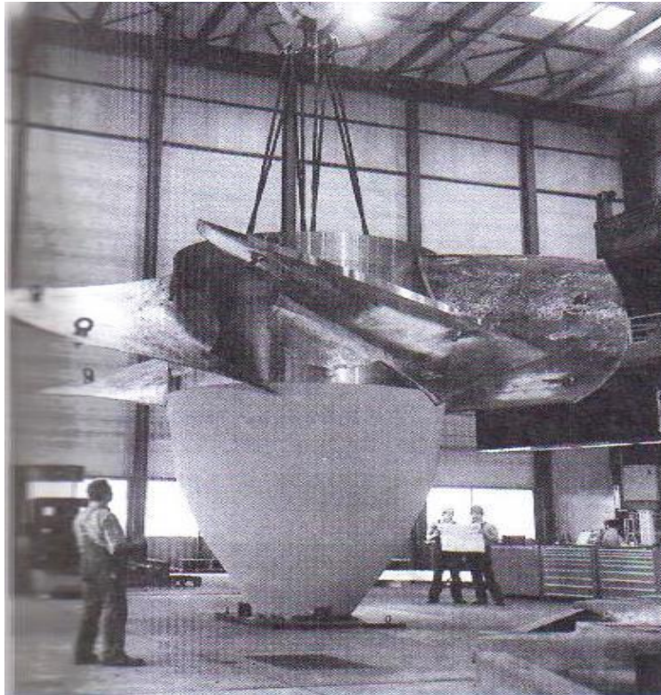
Τροχός στροβίλου τύπου Kaplan
