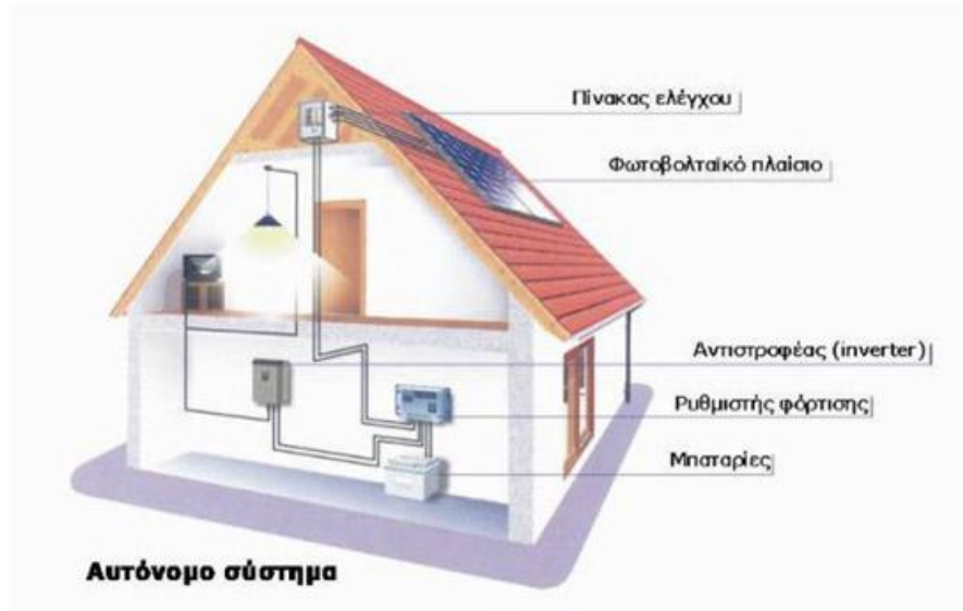
Σχήμα 4.1: Οικιακό αυτόνομο σύστημα παραγωγής ηλεκτρικής ενέργειας
