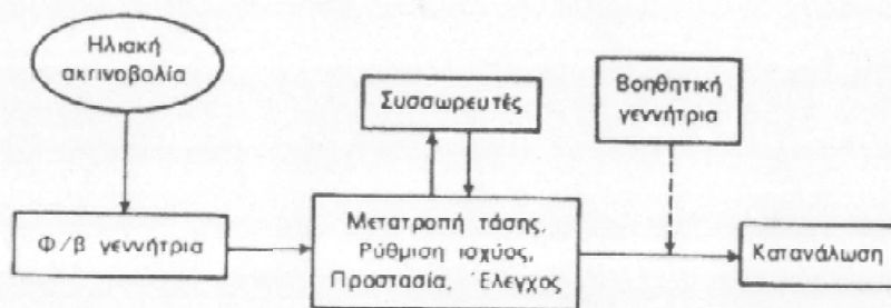
Σχήμα 4.1: Παραδείγματα γενικού διαγράμματος ενός αυτόνομου φ/β συστήματος
