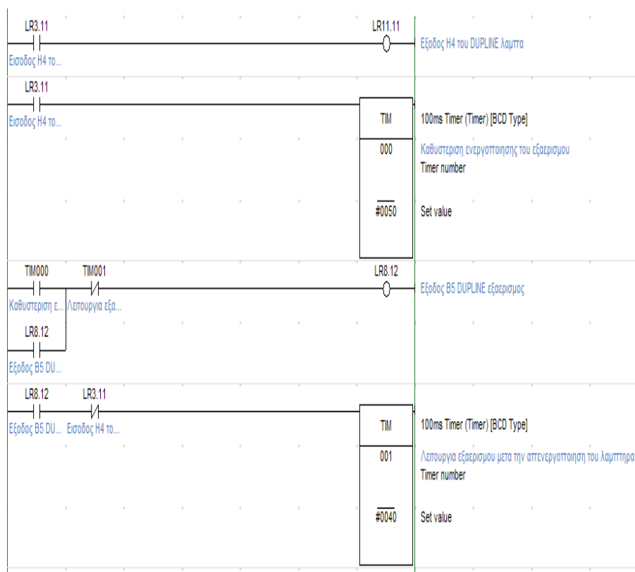
Σχήμα 4.6 Έλεγχος φωτισμού-εξαερισμού χώρων
