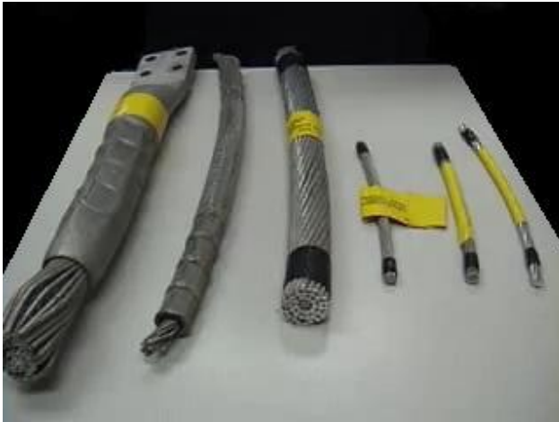
Αγωγοί και σύνδεσμοι υψηλής τάσης
