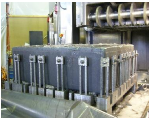
Εικόνα 4.7 ΤΟΠΟΘΕΤΗΣΗ INGOT ΣΤΗ ΜΕΤΑΛΛΙΚΗ ΒΑΣΗ ΚΑΙ ΦΟΡΤΩΜΑ ΣΤΟ ΠΡΙΟΝΙ
