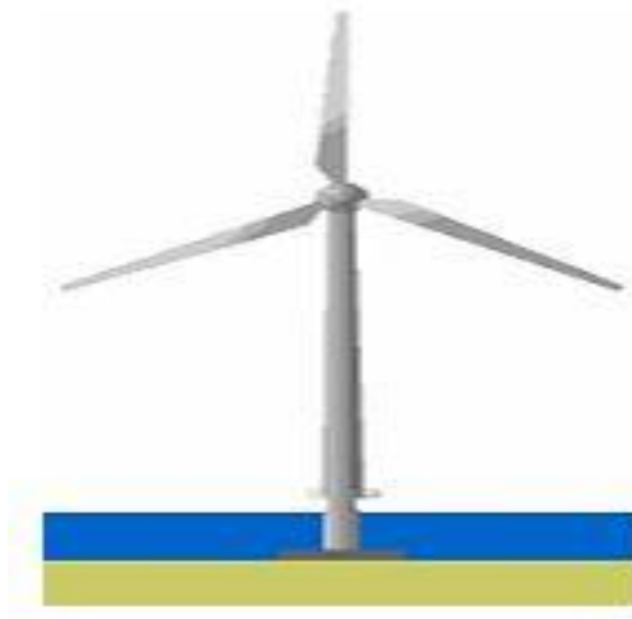
Σχήμα 2.12 Ο δεύτερος τύπος κατασκευής από μεταλλικό σωλήνα.
