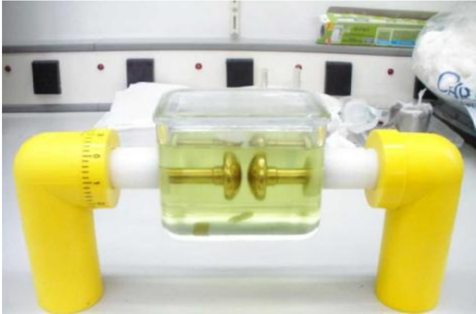
Εικόνα 7-7 :Γέμισμα της κυψέλης με έλαιο, εισαγωγή του stirrer και σφράγιση της κυψέλης με το ειδικό καπάκι. [34]
