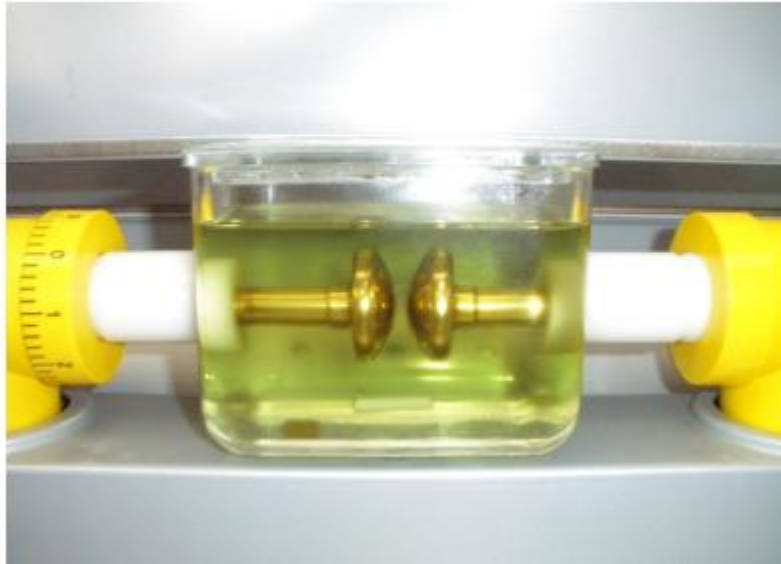
Εικόνα7-2 :Η απαιτούμενη η συνεχής ανάδευση επιτυγχάνεται με ένα κινητό μαγνητάκι (stirrer) που τοποθετείται στον πάτο της κυψέλης και περιστρέφεται μέσω ειδικής διάταξης μαγνητών στο εσωτερικό του BAUR. [34]
