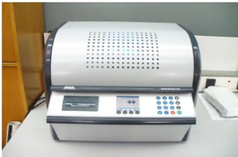
Εικόνα 7-4 : Μόνο όταν κλείσει το καπάκι μπορεί να εκκινήσει η διαδικασία των μετρήσεων[34]
