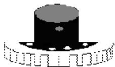
Εικόνα 5.8 Βάση του μεγάλου γραναζιού μαζί με το γρανάτζι
