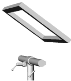
Εικόνα 5.15 Η βάση στήριξης του Φ/Β πλαισίου
