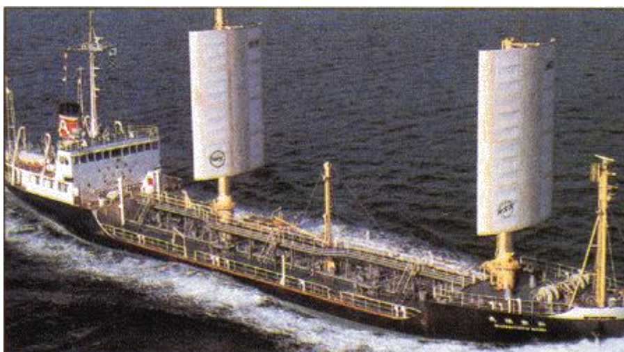
Εικόνα 1: Πετρελαιοφόρο με αεροδυναμικά ιστία
