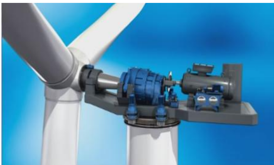
Εικόνα 6: Το κουβούκλιο Α/Γ με την πλήμνη και τον κύριο άξονα χαμηλών και υψηλών στροφών
