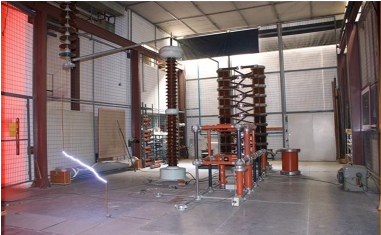
Σχήμα 4.A: Γύρω από την διάταξη παραγωγής υψηλής τάσης φαίνεται ο προστατευτικός φράκτης ( από το Εργαστήριο Υψηλών Τάσεων του Αριστοτελείου Πανεπιστημίου Θεσσαλονίκης ).
