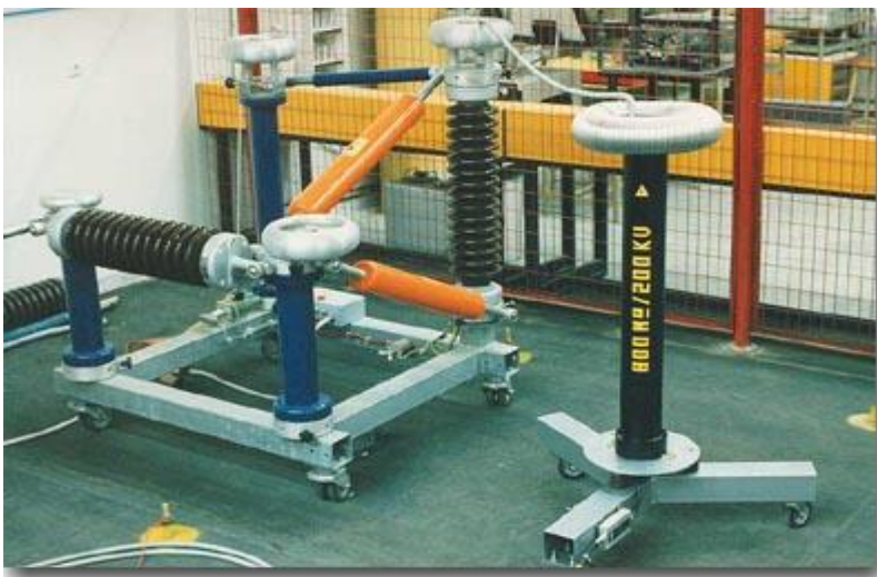
Σχήμα 4.B: Πίσω από την διάταξη παραγωγής υψηλής τάσης φαίνεται ο προστατευτικός φράκτης ( από το Εργαστήριο Τεχνολογίας Υψηλών Τάσεων του TEI Χαλκίδας ).
