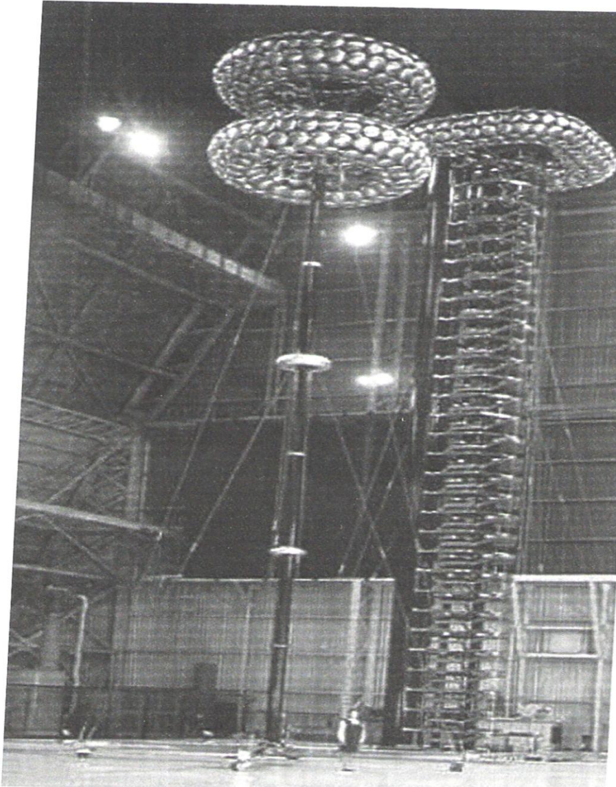
Σχήμα 1.Φ: Η γεννήτρια Marx 30 βαθμίδων 3 MV, 450 KJ ( της εταιρίας Haefely ).
