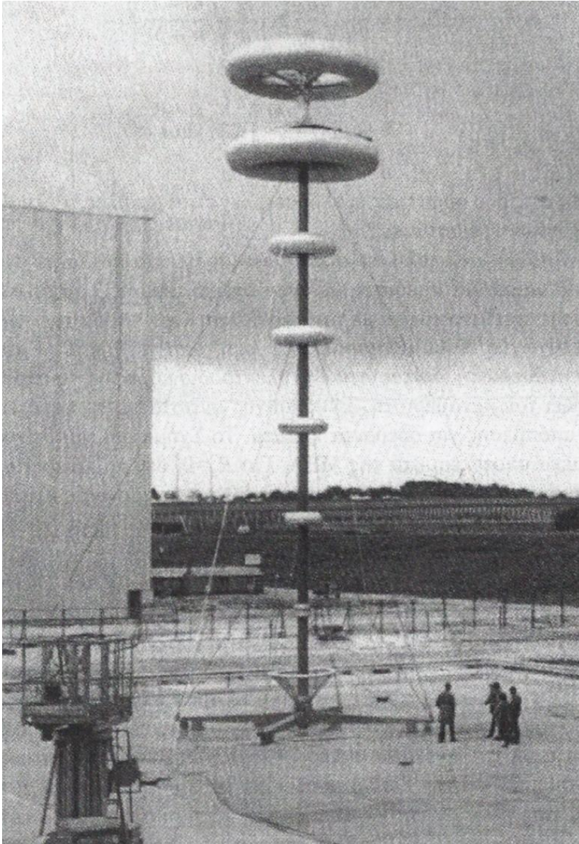
Σχήμα 1.Ξ1: Χωρητικός καταμεριστής τάσης με εν σειρά απόσβεση για κρουστική τάση 6 MV (ευγενική προσφορά EdF, Les Renardieres, Γαλλία).
