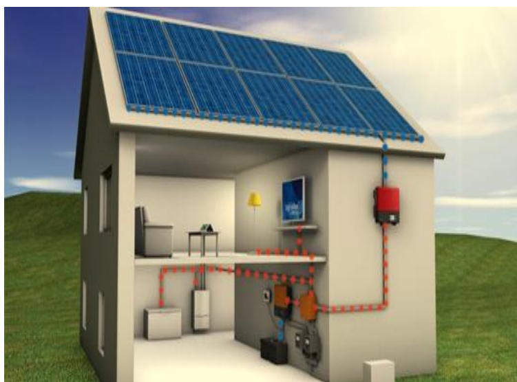
Εικόνα. Αυτόνομο φωτοβολταϊκό σύστημα
