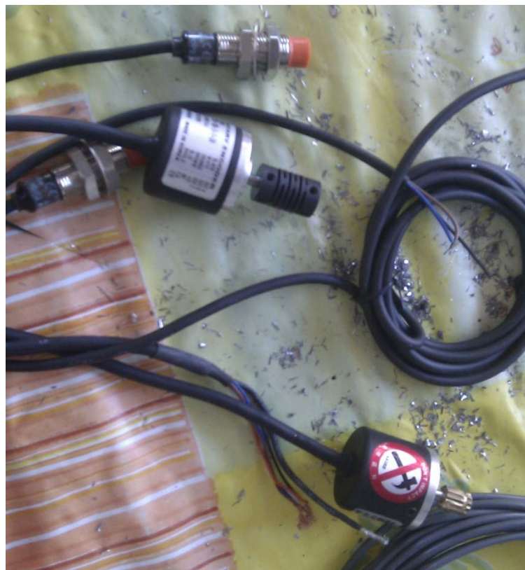
Εικόνα 6.16: Επαγωγικοί διακόπτες και encoder.
