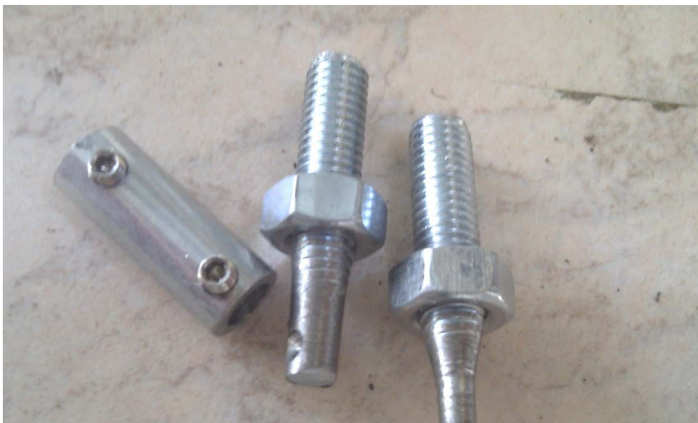
Εικόνα 6.10: Το κόμπλερ και οι άξονες για την κίνηση πάνω - κάτω.
