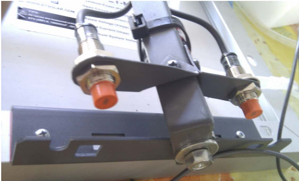
Εικόνα 6.9: Επαγωγικοί διακόπτες για την κίνηση πάνω – κάτω.
