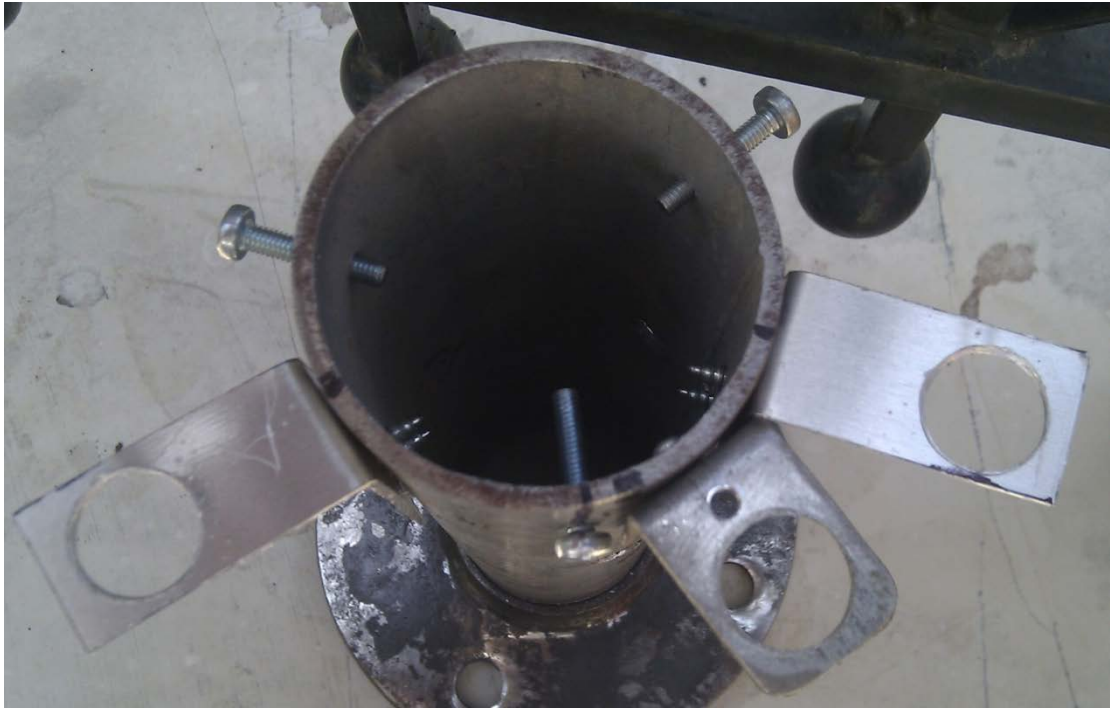
Εικόνα 6.13: Προσαρμογή των βάσεων των επαγωγικών και του encoder στην κεντρική βάση του.
