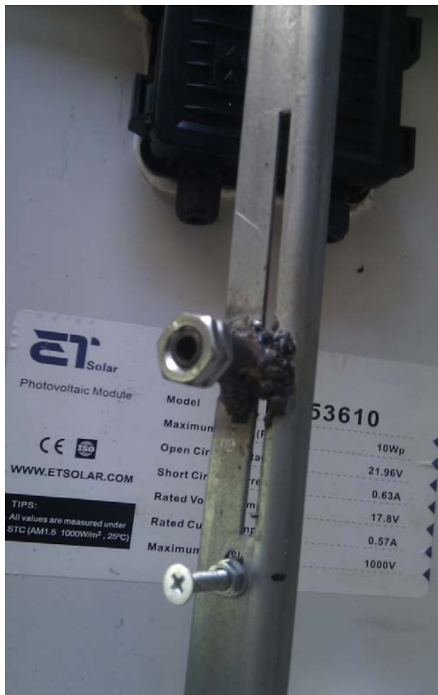
Εικόνα 6.12: Ο άξονας για την κίνηση ανατολή-δύση και η βάση των χειριστηρίων.
