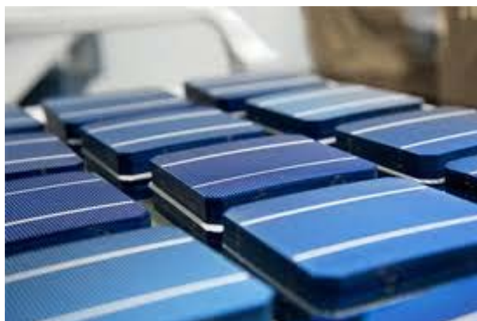
Εικόνα 2.10: Κυψέλες Φωτοβολταϊκών πλαισίων.
