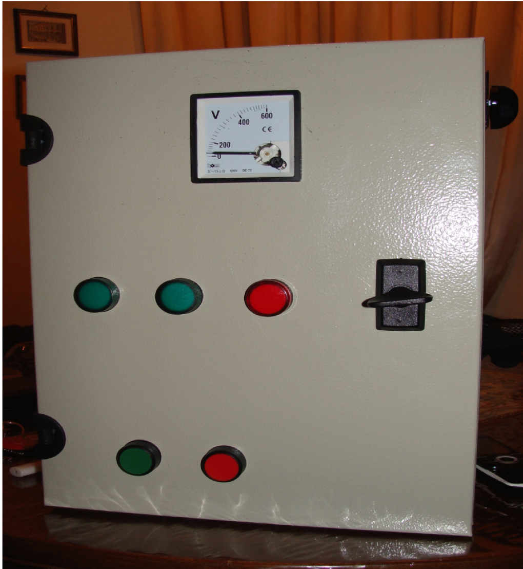
Εγκατάσταση μπουτόν start-stop, ενδεικτικών λυχνιών, βολτομέτρου, ράγα στήριξης και περιστροφικού διακόπτη.
