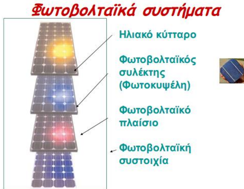
Σχήμα 2: Περιγραφή ενός φωτοβολταϊκού στοιχείου
