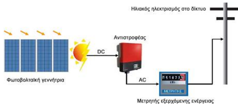
Σχήμα 4.9: Αναπαράσταση παραγωγής ηλεκτρικής ενέργειας και πώληση αυτής
