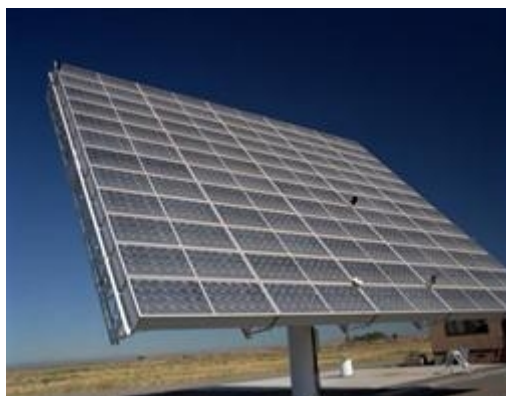
Εικόνα: Ηλιοτρόπιο δυο αξόνων
