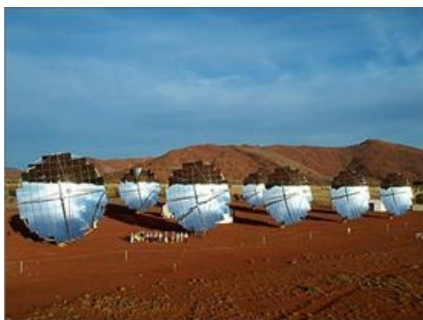
Εικόνα 2: Ηλιοτρόπια με παραβολικά κάτοπτρα
