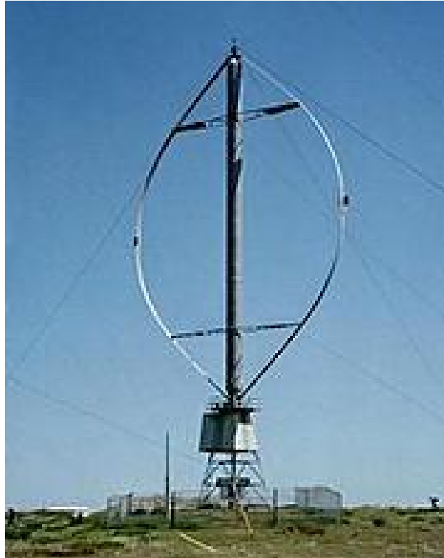
Ανεμογεννήτρια κατακόρυφου άξονα
