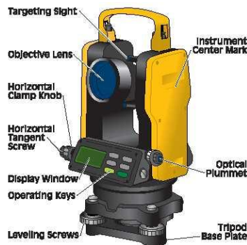
Εικόνα 3. 17 Μέρη του θεοδόλιχου
