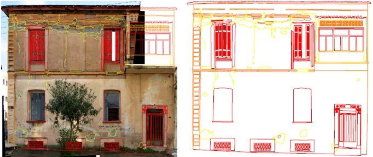
Εικόνα 3. 13 Φωτογραμμετρική απόδοση και τελικό διάγραμμα όψης διατηρητέου κτιρίου
