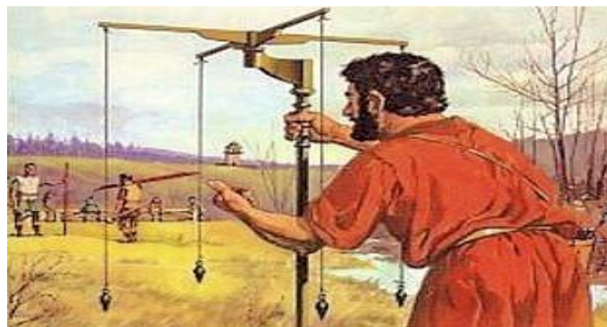
Εικόνα 3. 19 Ρωμαίος μηχανικός χρησιμοποιεί αρχαίο είδος θεοδόλιχου.
