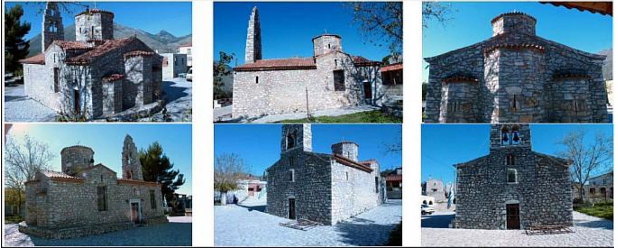
Εικόνα 3. 11 Φωτογραμμετρικές λήψεις για την εφαρμογή συγκλίνουσας μη στερεοσκοπικής επεξεργασίας
