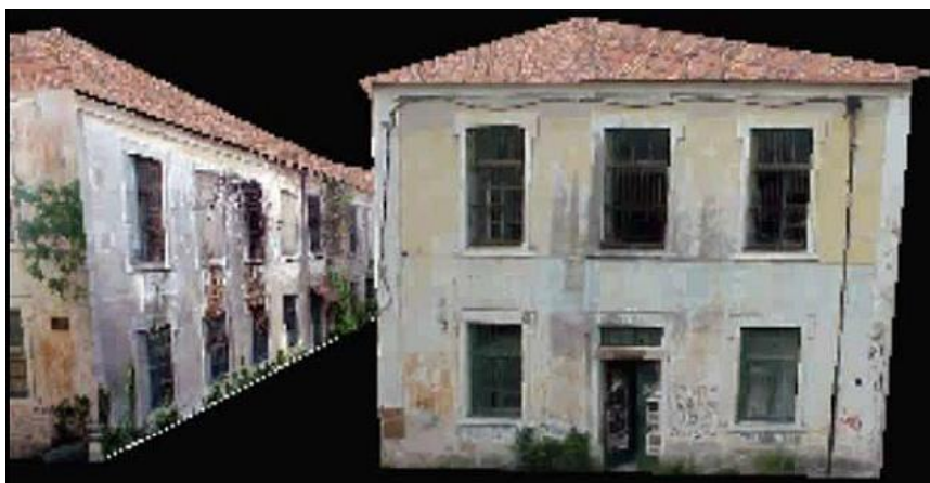
Εικόνα 3. 14 Εικονικό μοντέλο φωτογραμμετρικής αποτύπωσης επίπεδων όψεων κτιρίου
