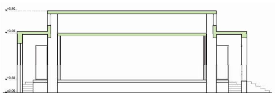
223. Οριζόντια φέροντα στοιχεία- πλάκες οροφής
