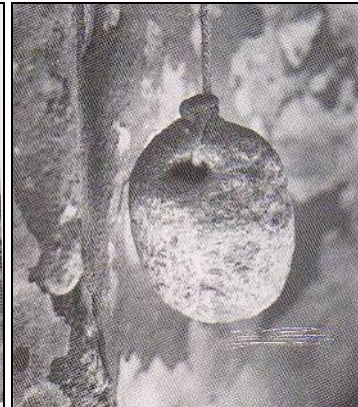
εικ.95. Κρεμαστή τράπεζα με τον ανεβάτη και την καβίλια (Πηγή: Ο ανεμόμυλος στις Κυκλάδες)
