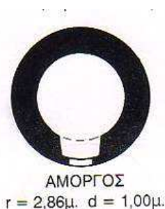
Σχ.1. Σχέση ακτίνας και πάχους τοιχοποιίας στους μύλους της Αμοργού (Πηγή: Ο ανεμόμυλος στις Κυκλάδες)
