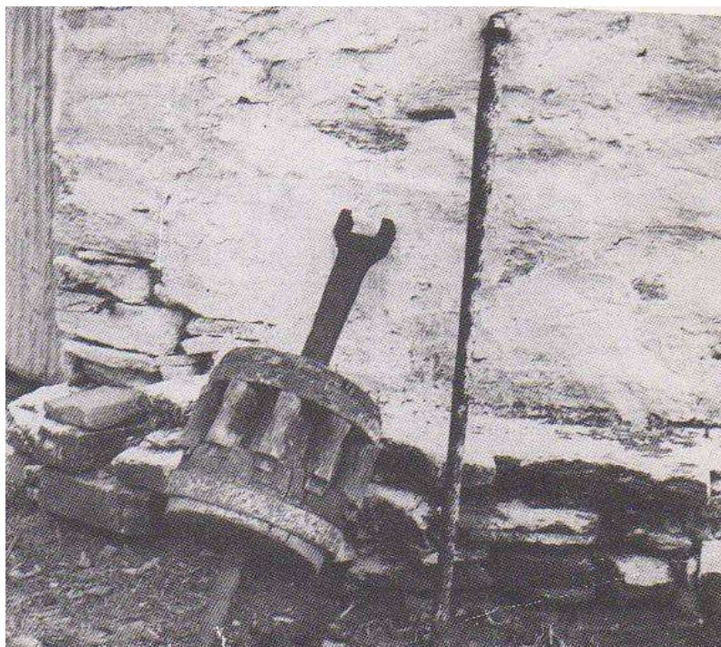
εικ.88. Ανέμη με βασιλικό σίδερο και λιμπουνάρι (Πηγή: Ο ανεμόμυλος στις Κυκλάδες)
