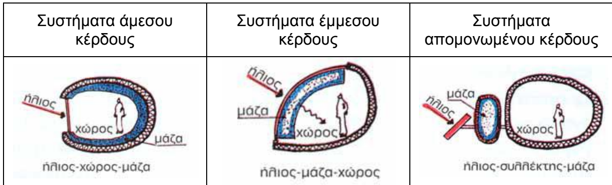
Εικόνα 13: Οι διατάξεις που χρησιμοποιούμε για τη συλλογή της ηλιακής ενέργειας σε εφαρμογές παθητικής ηλιακής Θέρμανσης.
