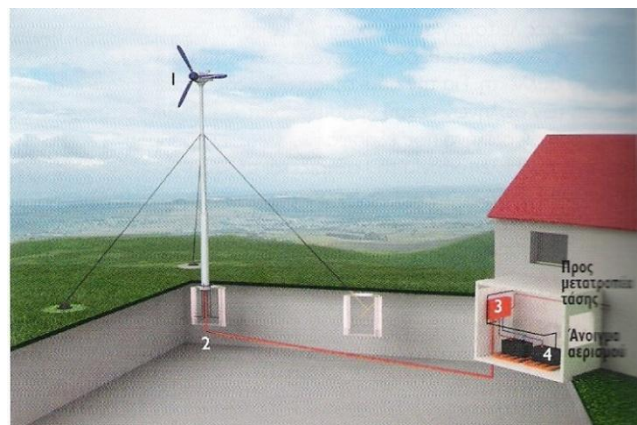
Εικόνα 91: Ηλεκτρολογική σύνδεση ανεμογεννήτριας για οικιακή χρήση.:1.Ανεμογεννήτρια, 2. Θεμελίωση ιστού ανεμογεννήτριας, 3. Ρυθμιστής φόρτισης των συσσωρευτών, 4. Συστοιχία συσσωρευτών (μπαταριών).
