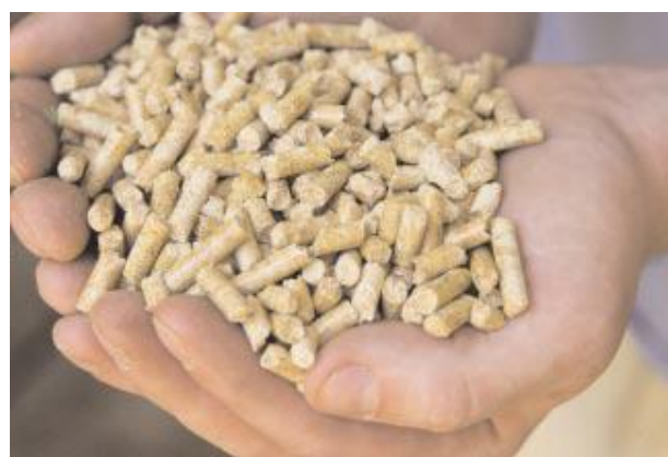
Εικόνα 93: Μια μορφή βιομάζας: pellets (συσσωματώματα) τα οποία προκύπτουν από τη μηχανική συμπίεση πριονιδιού, χωρίς την προσθήκη χημικών ή συγκολλητικών ουσιών.
