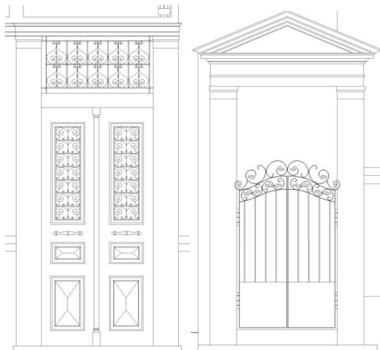
Εικόνα 51. Λεπτομέρεις νέου εξώθυρων. Αριστερά κεντρική ισογείου, δεξιά μεταλλική ακάλυπτου χώρου.
