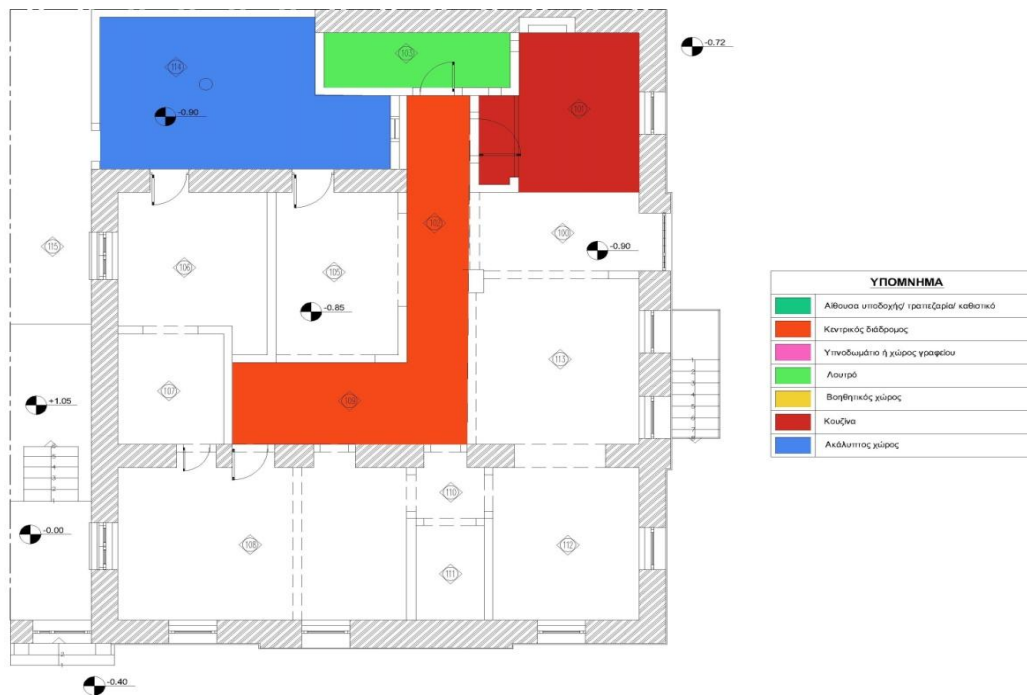
Εικόνα 4. Χρωματική κάτοψη ημιυπόγειου με ανάλυση χώρων ανά χρήση.
