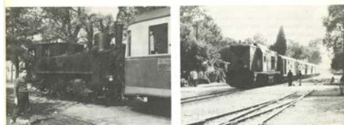
Αριθμός Ζε 7535 2-6-0Τ των ΣΠΑΠ στο σταθμό της Τριπόλης - 1967. Δοξολάμια 9201 Co Co Alsthom των ΣΠΑΠ στο σταθμό του Ρίου - 1934.
