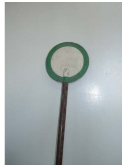
ΣΗΜΑΤΟΔΟΤΗΣΗ ΣΤΑΘΜΑΡΧΟΥ ΓΙΑ ΑΝΑΧΩΡΗΣΗ ΤΡΕΝΟΥ
