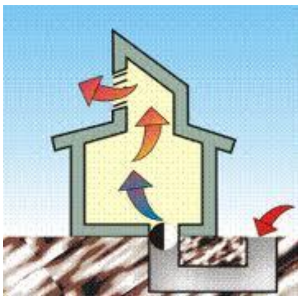
Εικ. 18 Εναλλακτικής Θερμότητας Εδάφους –Αέρα Ανοιχτού Κυκλώματος
