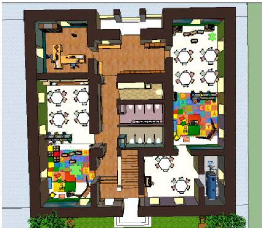
Εικόνα 65 Κάτοψη ισογείου (πρόταση)
