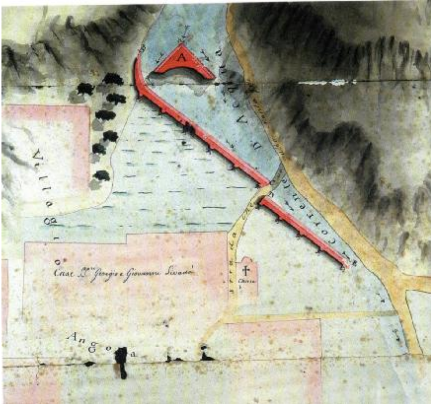
ΕΙΚ.74: Τοπογραφικό προτεινόμενης κατασκευής φράγματος στον Αγκώνα Θηνιάς.
