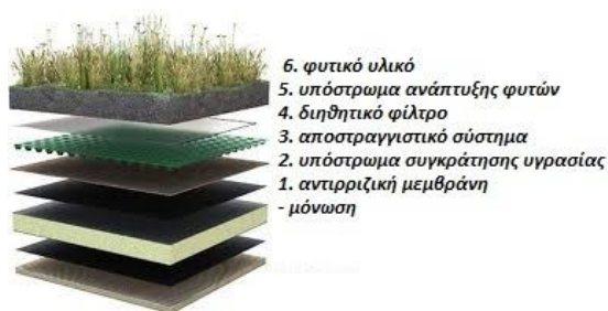
Εικόνα 204: Διαστρωμάτωση υλικών φυτεμένου δώματος τα υλικά:
