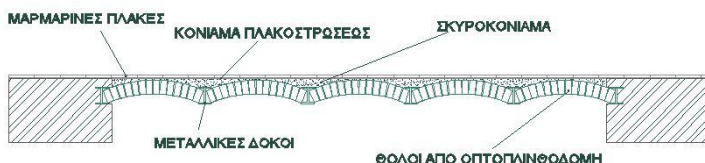
Εικόνα 56 λεπτομέρεια συστήματος carpen
