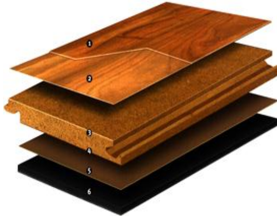
Εικόνα13)1. Υψηλής αντοχής με προστατευτικό film 2. Διακοσμητικό decor ειδικής επεξεργασίας 3. Πυρήνας HDF, με επεξεργασία κατά της υγρασίας τάξης E1 4. Σύστημα εφαρμογής Lock Connect με AquaBlock 5. Υλικό εξισορρόπησης τάσεων 6. Ηχομονωτικό υλικό silent πάχους 2mm (προαιρετικό)
