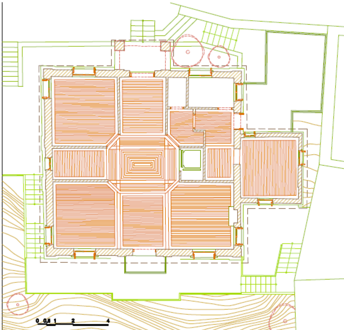
Ξύλινη οροφή πρότασης στην Γ στάθμη(είσοδος)
