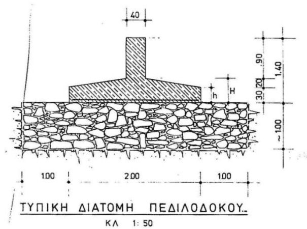
Εικόνα 196. Τυπική διατομή Πεδιλοδοκού.
