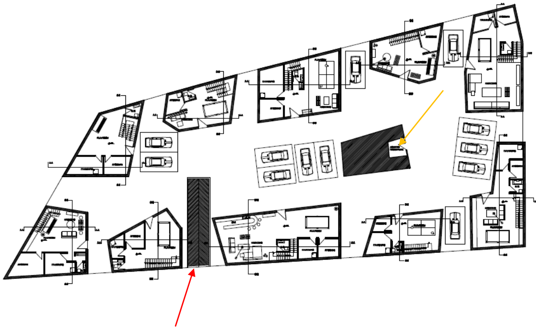
Εικόνα 78: Κάτοψη υπόγειου κοινόχρηστου χώρου. Κόκκινο βελάκι: κεντρική ράμπα που οδηγεί στο υπόγειο. Κίτρινο βελάκι δωμάτιο γεωθερμίας.
