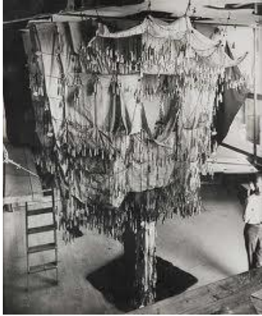
Εικ.49: Το βάρος των σάκων στο μοντέλο αντιστοιχούσε κατ' αναλογία 1:10.000
