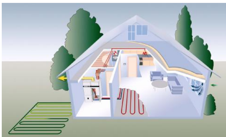
Εικ. 67: Λεπτομέρεια τοποθέτησης οριζόντιου γεωθερμικού συστήματος
