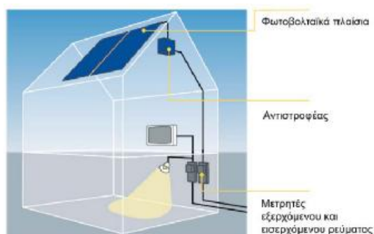
Εικ.66: Λεπτομέρεια τοποθέτησης φωτοβολταϊκών συστημάτων.
