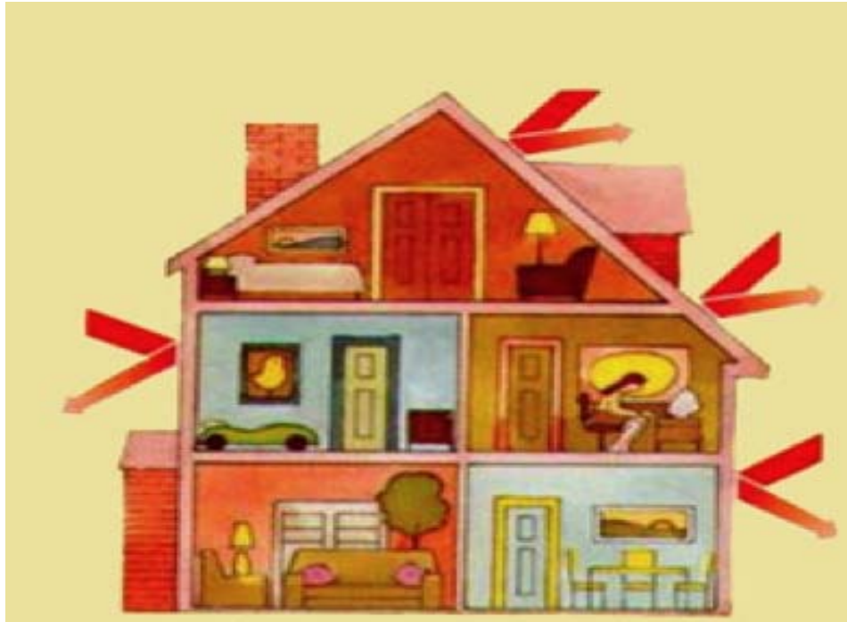
Εικόνα 3.13: Ανακλαστικά επιχρίσματα εξωτερικών επιφανειών
