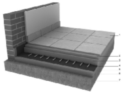
Εικόνα 65 Τομή ενδοδαπέδιας θέρμανσης σε δάπεδο με πλακίδια
