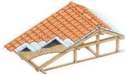
Θερμομόνωση κεκλιμένων στεγών
