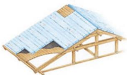
Θερμομόνωση κεκλιμένων στεγών
