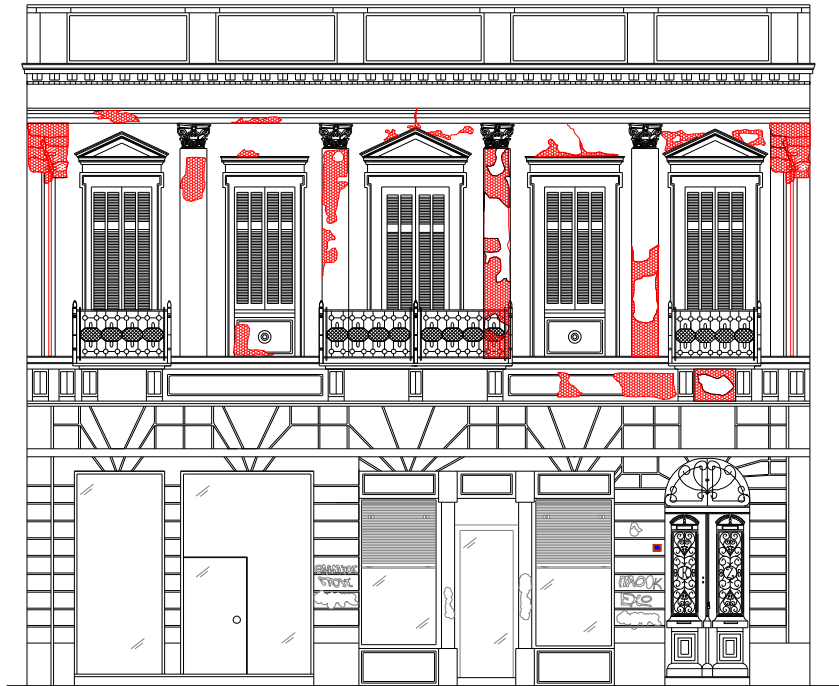
εικ.84: Αποκόλληση επιχρίσματος, κονιάματος και λιθοδομής.
