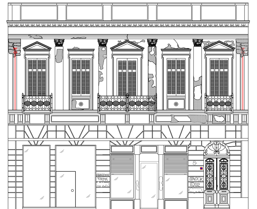
εικ.82: Απολήξεις μεταλλικών ελκυστήρων
