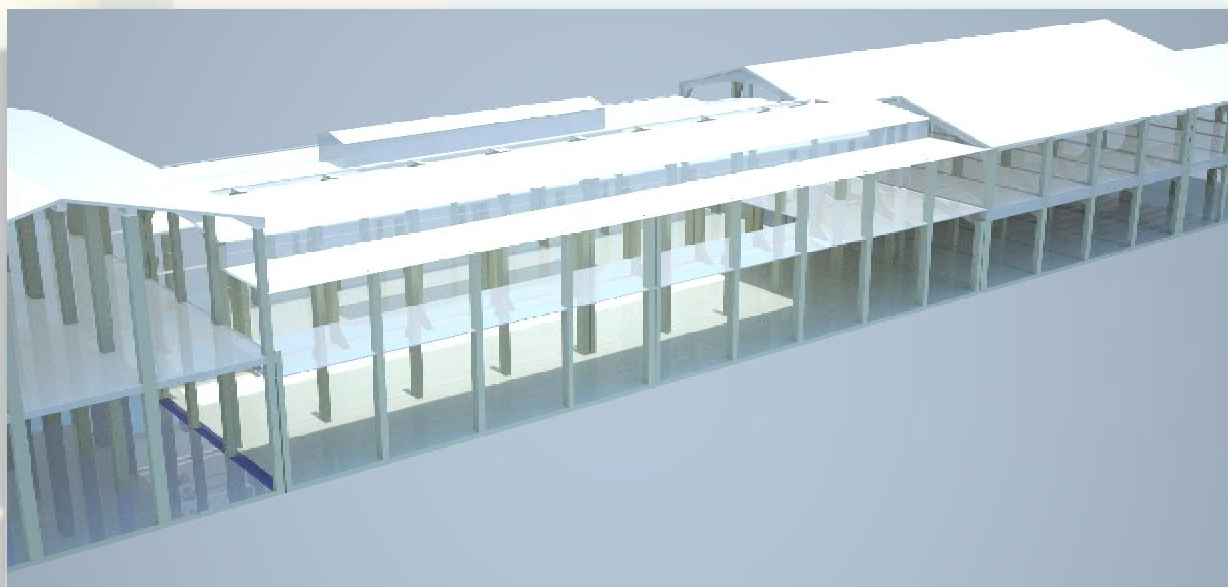
Σχ. 12– Τρισδιάστατη απεικόνιση διάταξης στοιχείων φέροντος οργανισμού
