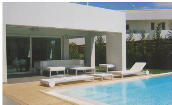
Εικόνα 2: Τα κατακόρυφα δομικά στοιχεία που προστατεύουν τα μεγάλα ανοίγματα από την λακή ακτινοβολία.
