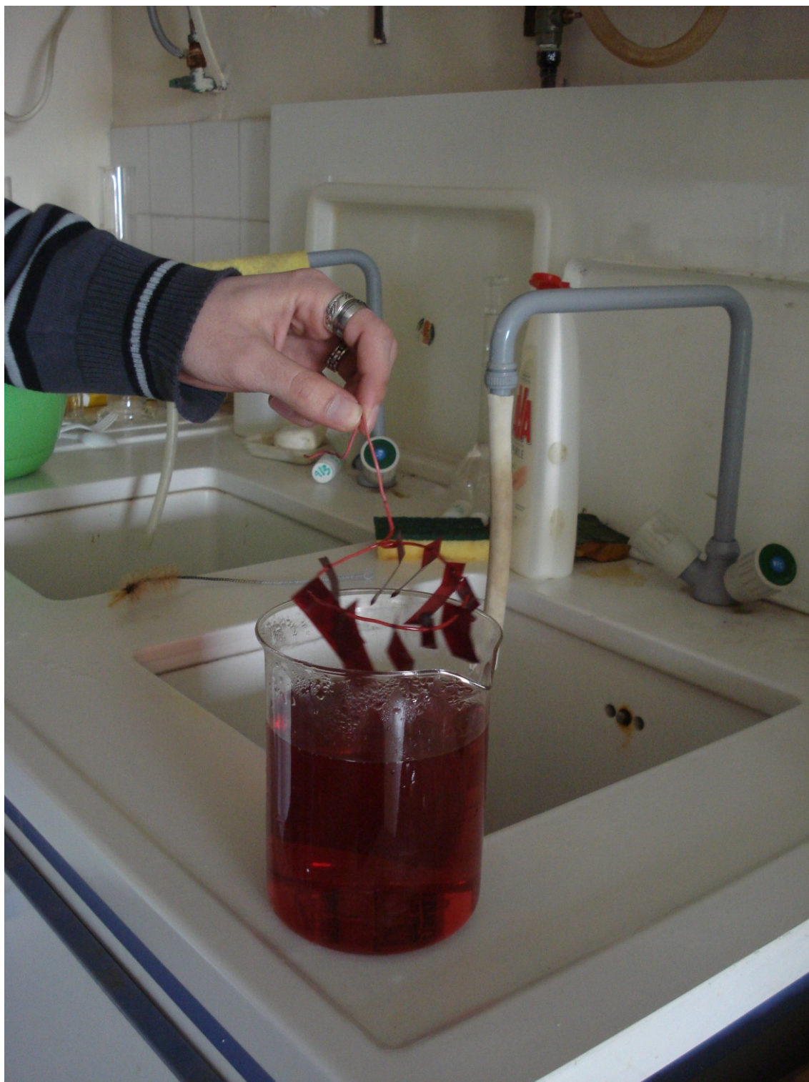
Εικόνα 8- 21 Μετά το πέρας των 90 min, τα film αναδύονται από το διάλυμα. Παρατηρούμε ότι η διάστρωση της νιτρικής κυτταρίνης η οποία είχε πάχος 12μm έχει διαβρωθεί χρωματίζοντας το διάλυμα σε καφέ απόχρωση καθώς επίσης έχει μειωθεί και το πάχος διάστρωσής της κάνοντας πιο ευδιάκριτα τα ίχνη για την καταμέτρηση που πρόκειται να επακολουθήσει [προσωπικό αρχείο] .
