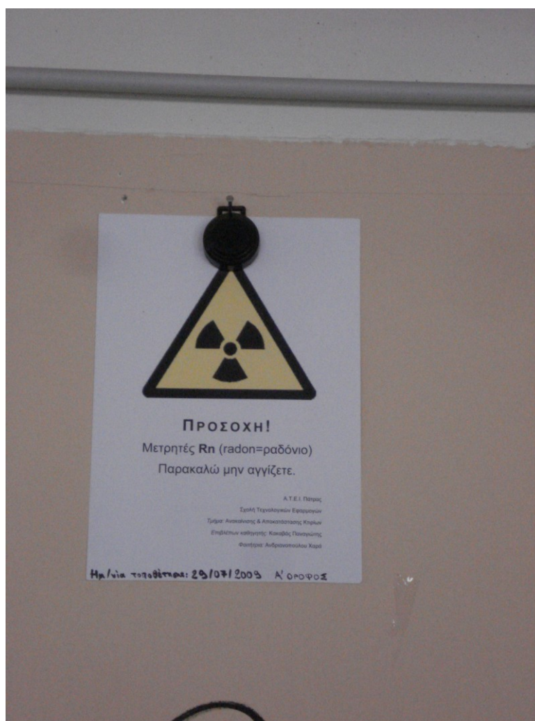
Εικόνα Α- 6 Μετρητής ( 7^{06} ) Tastrak της TASL στο χώρο διαλλείματος στον 1 ο όροφο [προσωπικό αρχείο]
