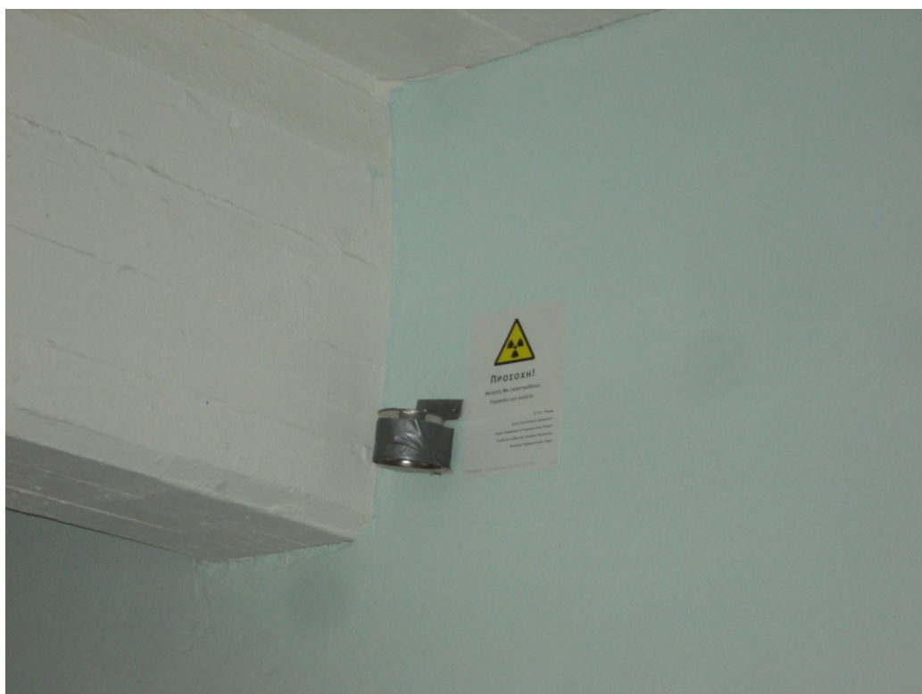
Εικόνα A- 8 Μετρητής (10 ος ) LR-115 II στα σχεδιαστήρια Β1 του 2 ου ορόφου [προσωπικό αρχείο]
