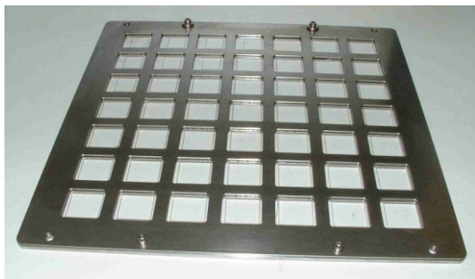
Εικόνα 8- 3 Μεγάλου μεγέθους Etch δίσκος, με διαμορφωμένες υποδοχές για 49 TASL και κωδικοποίηση ανιχνευτών, 25 τετραγωνικών η κάθε μία [αναφορά 53] .
