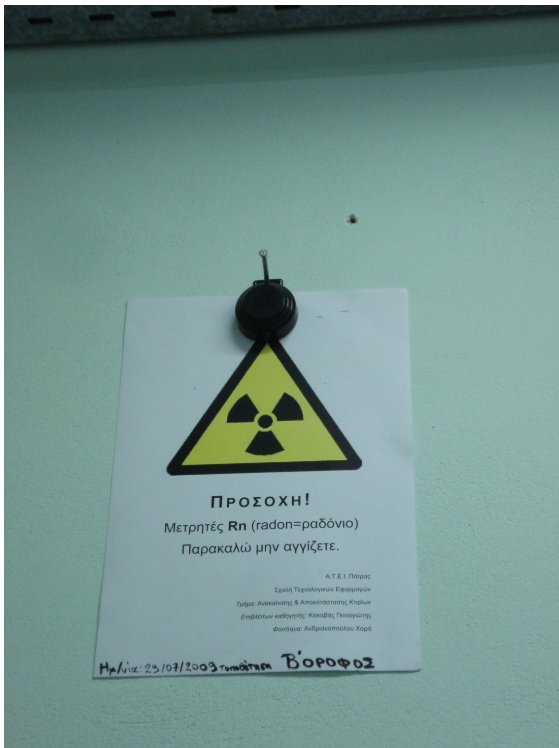
Εικόνα Α- 9 Μετρητής ( ^{110\text{S}} ) Tastrak της TAsL στο χώρο διαλλείματος στον 2 ο όροφο [προσωπικό αρχείο]
