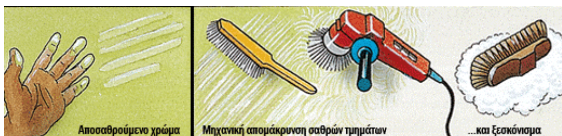
Εικόνα 7- 5 Εξυγίανση υπόβαθρου τοιχίων υπογείου [αναφορά 49]
