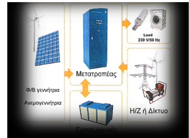
Περιγραφή υβριδικού φωτοβολταϊκού συστήματος
