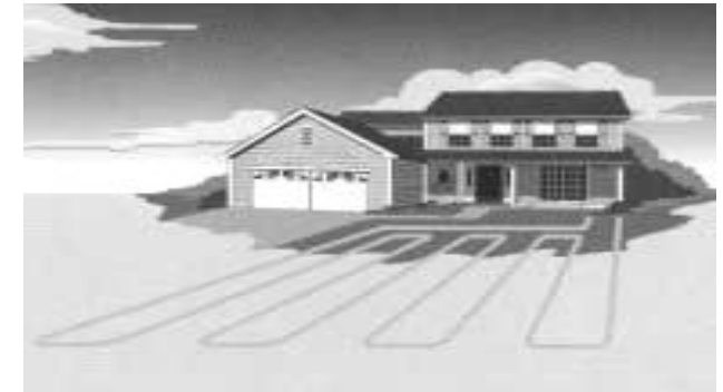
Γεωεναλλάκτης κλειστού κυκλώματος Οριζόντιος
