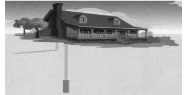
Γεωεναλλάκτης ανοιχτού κυκλώματος με χρήση γεωτρήσεων
