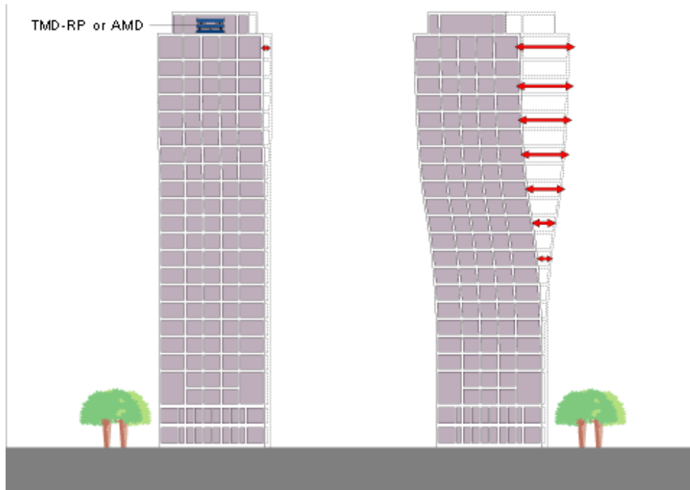
Εικόνα 5.11. α) Με το TMD-RP και β) Χωρίς το TMD-RP
