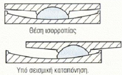
Εικόνα 6.11. Σφαιρικό Εφέδρανο Τριβής - Friction Pendulum System (FPS)
