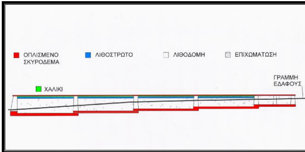
εικ.21 ΤΟΜΗ ΚΑΤΑ ΜΗΚΟΣ ΤΟΥ ΚΤΙΡΙΟΥ ΜΕΧΡΙ ΤΟ ΥΨΟΣ ΤΟΥ ΔΑΠΕΔΟΥ ΜΕ ΧΡΩΜΑΤΙΚΟ ΔΙΑΧΩΡΙΣΜΟ ΤΩΝ ΥΛΙΚΩΝ ΤΗΣ ΘΕΜΕΛΙΩΣΗΣ.
