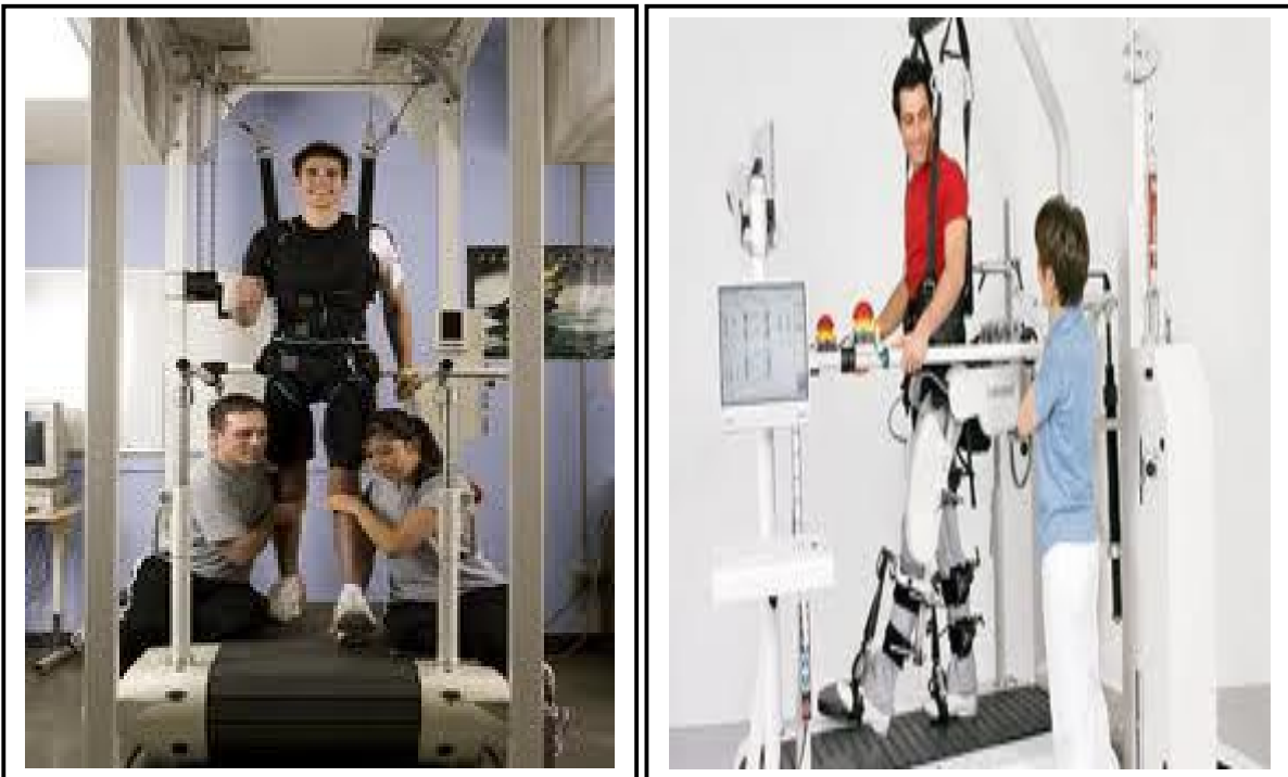
Εικόνα 5.5: Το Lokomat είναι ό,τι καλύτερο έχει να παρουσιάσει η ρομποτική ιατρική τα τελευταία χρόνια στο χώρο της αποκατάστασης. Αποτελείται από μια ρομποτική συσκευή βάδισης που προσαρμόζεται πλήρως στο σώμα του ασθενή, ένα ηλεκτρονικό διάδρομο και μια ειδική μονάδα ανάρτησης. (68)
