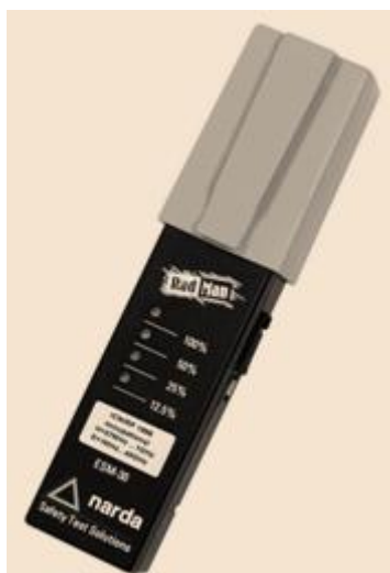
Εικόνα 4.7 Ανιχνευτής ακτινοβολίας Radman XT Narda.
