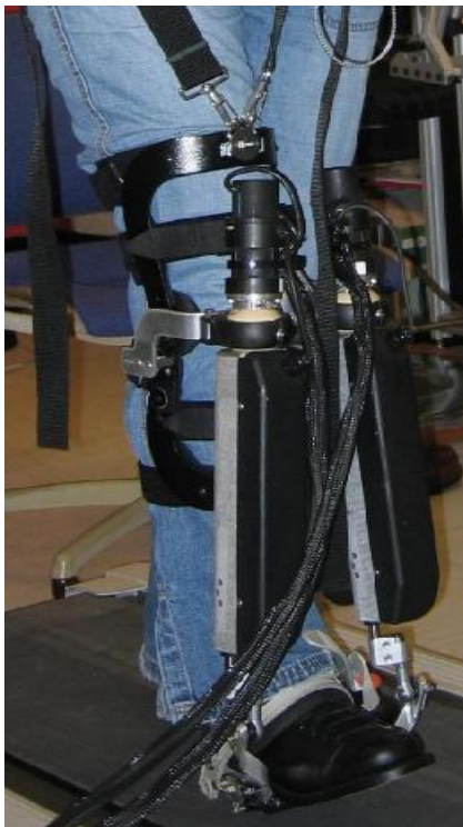
Εικόνα 2.9 Νάρθηκας_Anklebot (από University of Michigan Powered Orthosis, 2010)
