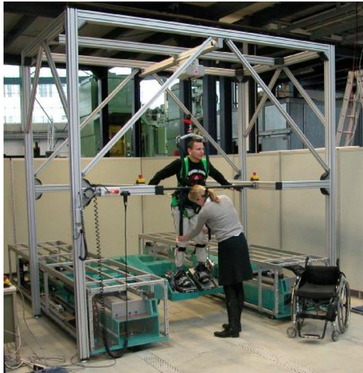
Εικόνα 2.7 HapticWalker, φωτογραφία του ρομποτικού προσομοιωτή βάρδισης (Henning Schmidt et al, 2007).
