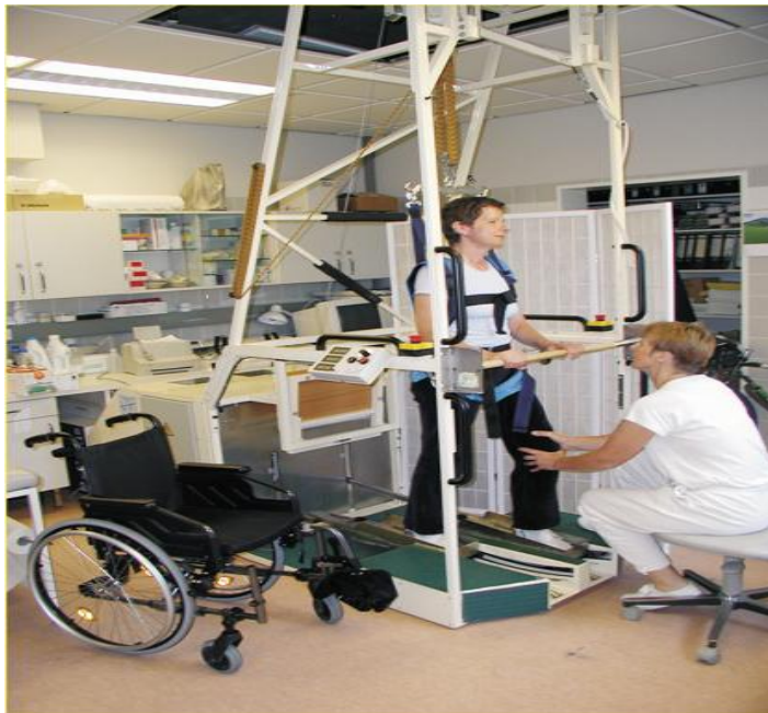
Εικόνα 2.6 Gait Trainer GT με ξεχωριστές πλατφόρμες για κάθε πόδι (Henning Schmidt et al, 2007).
