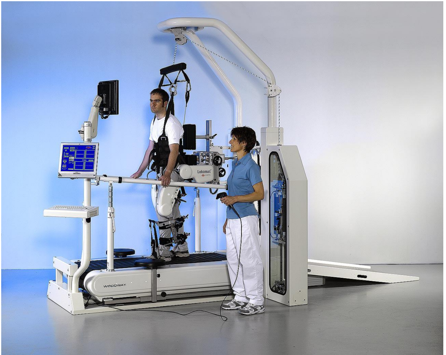
Εικόνα 2.1 Νάρθηκας Οδηγούμενης Βάδισης, Driven Gait Orthosis (DGO-Locomat) (Photo courtesy of Hocoma AG, Volketswil, CH).
