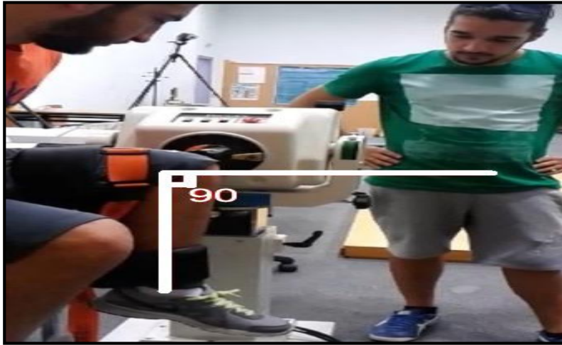
Εικόνα 3.5 Ρύθμιση ορίων παθητικής κινητοποίησης (από 0 0 έως 90 0 ) για τη μέτρηση της ελαστικότητας των οπίσθιων μηριαίων.
