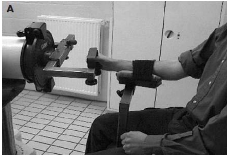
Εικόνα 38: Εφαρμογή του μηχανισμού ισοκινητικής συστολής για την προπόνηση των υπτιαστών μυών του πήχη. Πηγή: Croisier et al., 2007.
